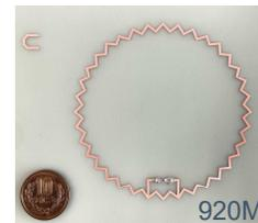
920MHz帯RFIDチップおよびループアンテナ
