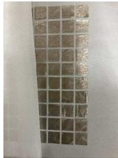
導電布を用いた柔軟な構造の人工磁気導体
